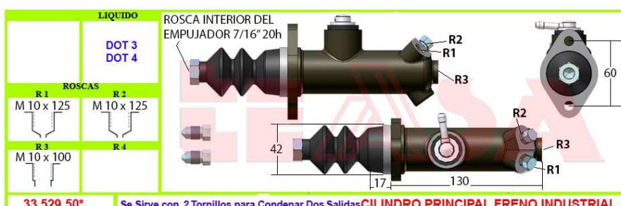
33.529.50* Se Sirve con 2 Tornillos para Condensar Dos Salidas CILINDRO PRINCIPAL FRENO INDUSTRIAL
